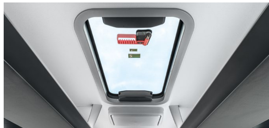
Botole sul tetto di grandi dimensioni in vetro sfumato traslucido
