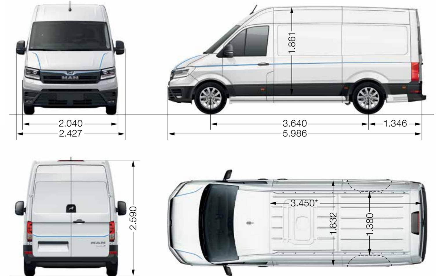
\* Longitud de carga en la parte superior: 3.201 mm.
