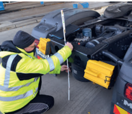
Passt alles? Strenge Kontrolle der Rahmenhöhe durch ETC-Tester Mario Müller
