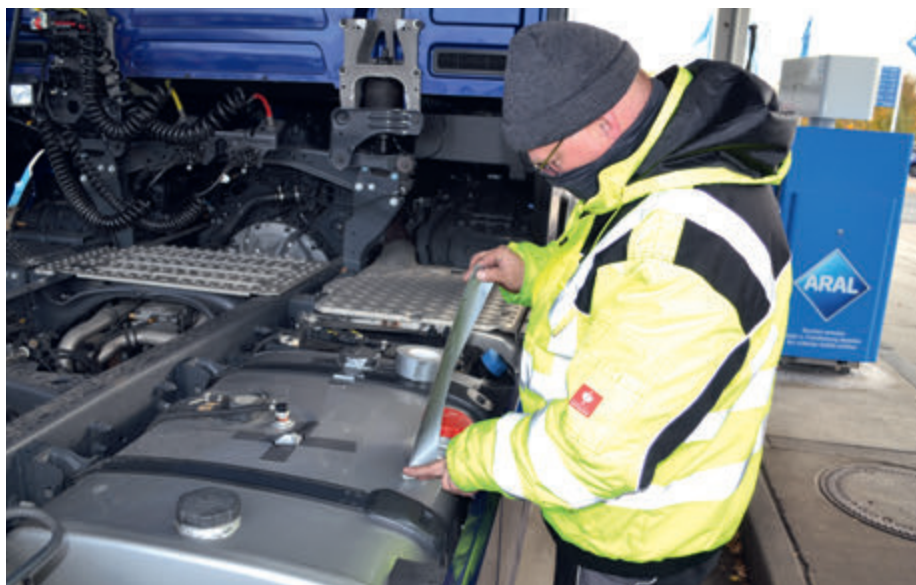
Ebenfalls Teil des ETC-Regelwerks: Nach dem Tanken wird der Zugang zum Dieselvorrat versiegelt.
